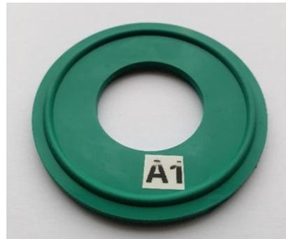
Abbildung 9 – FKM-Dichtung mit schlechter Oberflächengüte, bezogen von einem Online-Händler
