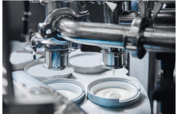
Abbildung 1 — Hygienische Dichtungen in Rohrkupplungen, die bei der Joghurtabgabe verwendet werden
