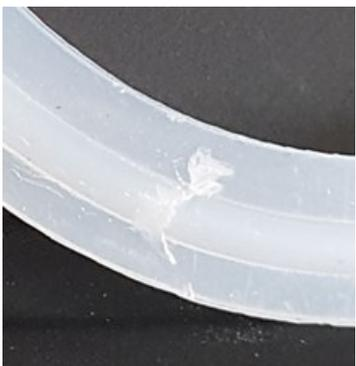
Abbildung 6 — Nahaufnahme einer Beschädigung einer anderen unbenutzten 2-Zoll-Silikondichtung (wie vom Händler geliefert)
