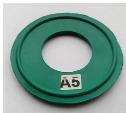
Abbildung 11 — Eine weitere FKM-Dichtung von schlechter Qualität mit unebenen Kanten, die von einem Online-Händler bezogen wurde
