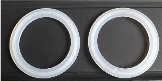
Abbildung 4 – Zwei 2-Zoll-Silikondichtungen, die vom Online-Händler beschädigt geliefert wurden
