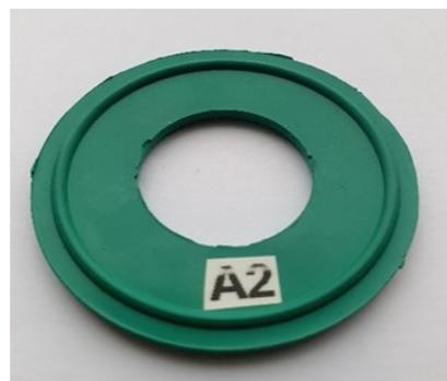
Abbildung 10 — FKM-Dichtung von schlechter Qualität mit unebenen Kanten, die von einem Online-Händler bezogen wurde
