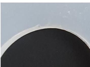
Abbildung 7 — Nahaufnahme von inneren Oberflächenfehlern an unbenutzter 2-Zoll-Silikondichtung (wie vom Händler geliefert)
